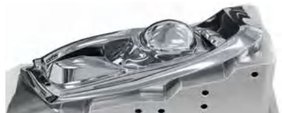
用于生产汽车前大灯的高度抛光模具。
