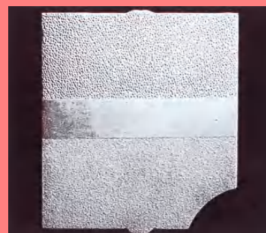
溶接後→時効処理 (500℃×1時間空冷)
